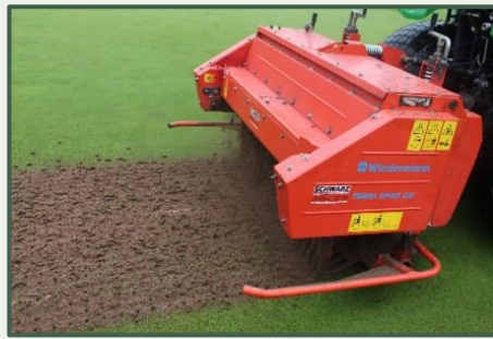
Schritt 2: Die überschüssige Erde wird aus den Löchern gedrückt.
