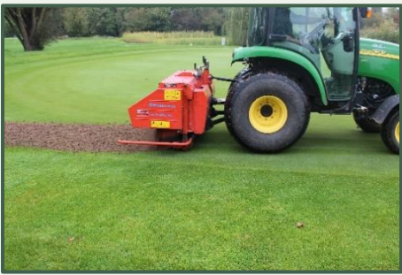
Schritt 1: Die Maschine sticht Löcher in die Rasenfläche.
