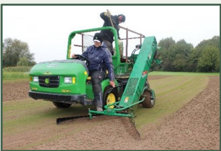
Schritt 3: Ein sogenannter Core-Harvester sammelt die Erde auf der Rasenfläche ein.
